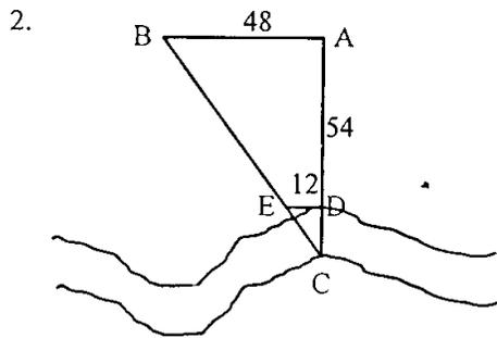
Pada kegiatan pengukuran lebar sungai dilakukan dengan menciptakan gambar dilokasi pengukuran seperti disamping. Jika bilangan-bilangan itu menyatakan panjang dalam satuan meter ; hitunglah lebar sungai di bagian antara titik C dan titik D.
